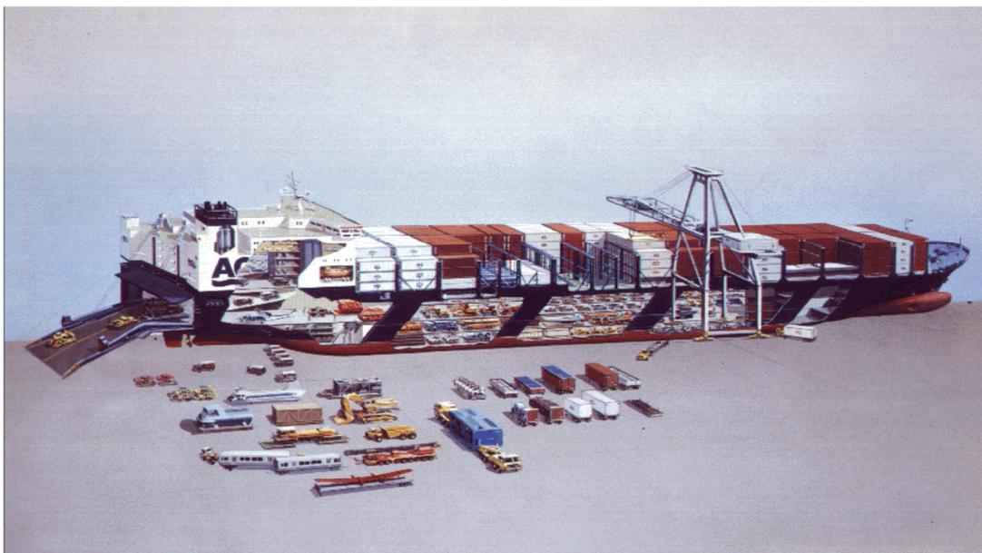
**Figura 4.3.1.2:** Navio Ro-Ro embarcando veículos
