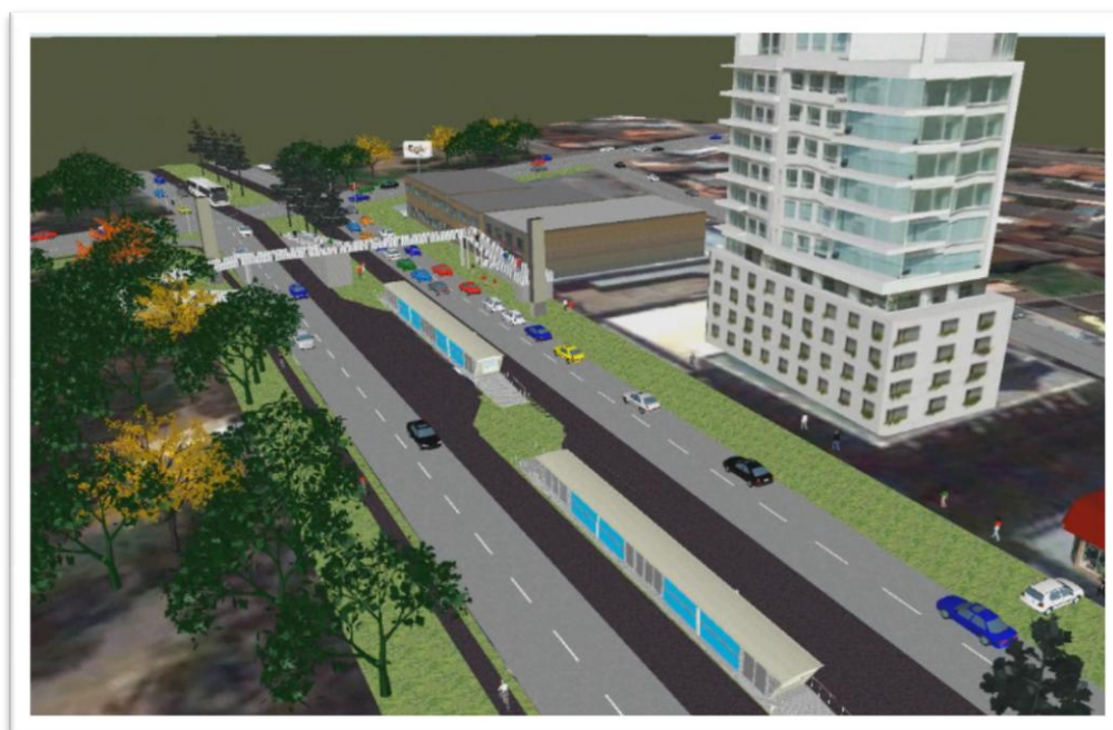
Figura 2-10: Configuração estação escalonada BRT –microsimulação Fonte: Autoria própria.
