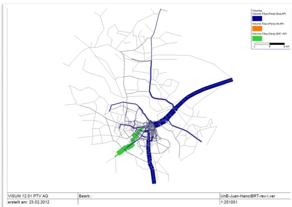
Figura 7-1 Fluxo geral na rede segundo os modos Bus, BRT e Pé
