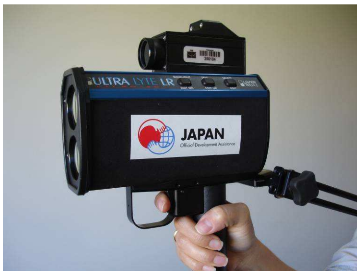
Figura 5.9: Medidor de velocidade portátil - ULTRA LYTE LR (LTI 20-20)
