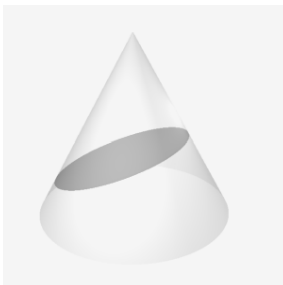
Figura 2.9: Obtenção de uma elipse a partir da intersecção de um cone por um plano
