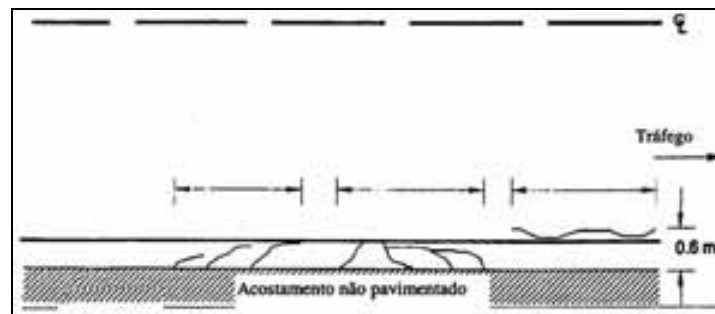
Figura 3.20 – Trincamento na borda (DNER, 1998)
